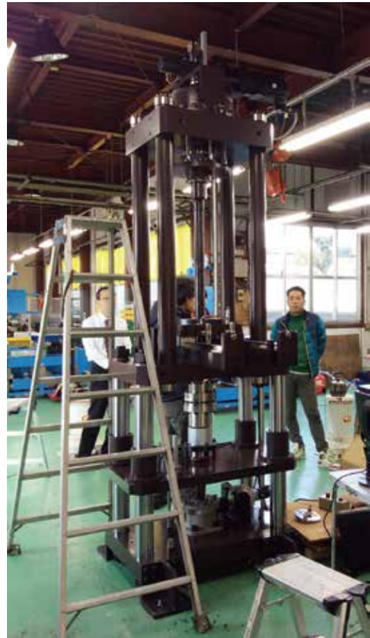
図2 回転摩擦試験機の本体プレスフレーム。現在は東京大学地震研究所の地下に設置されている。
