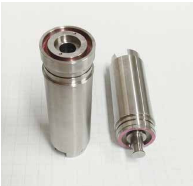
図1 熱水式回転摩擦試験機の試料部の実物大模型。下側の固定ピストン(左)の赤く着色した部分に粉末またはリング状試料を置き上側の回転ピストン(右)の着色部を嵌め合わせる。
