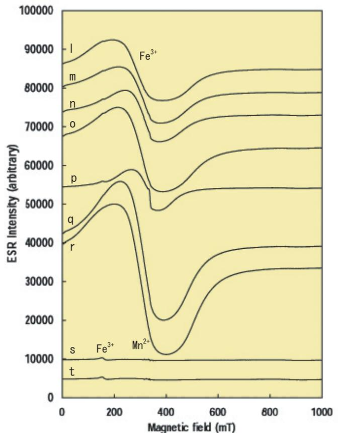
野島断層岩のESR解析結果(福地龍郎). マイクロ波出力は1mWで, 掃引磁場は上2つの図が $338 \pm 5$  mT, 下2つの図は $500 \pm 500$  mT. 図中のa, b, hは断層ガウジ, その他はシュードタキライト. 加熱実験結果を考慮すると, 図の結果からシュードタキライト形成時の摩擦温度は融点を越していたと考えられる.
